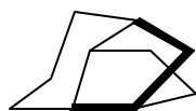
Figura 2-11 Ejemplo de enlaces estratégicos en un sistema puenteadado. Si se desconecta cualquiera de los enlaces marcados, se obtiene una estructura fusionada simple.
